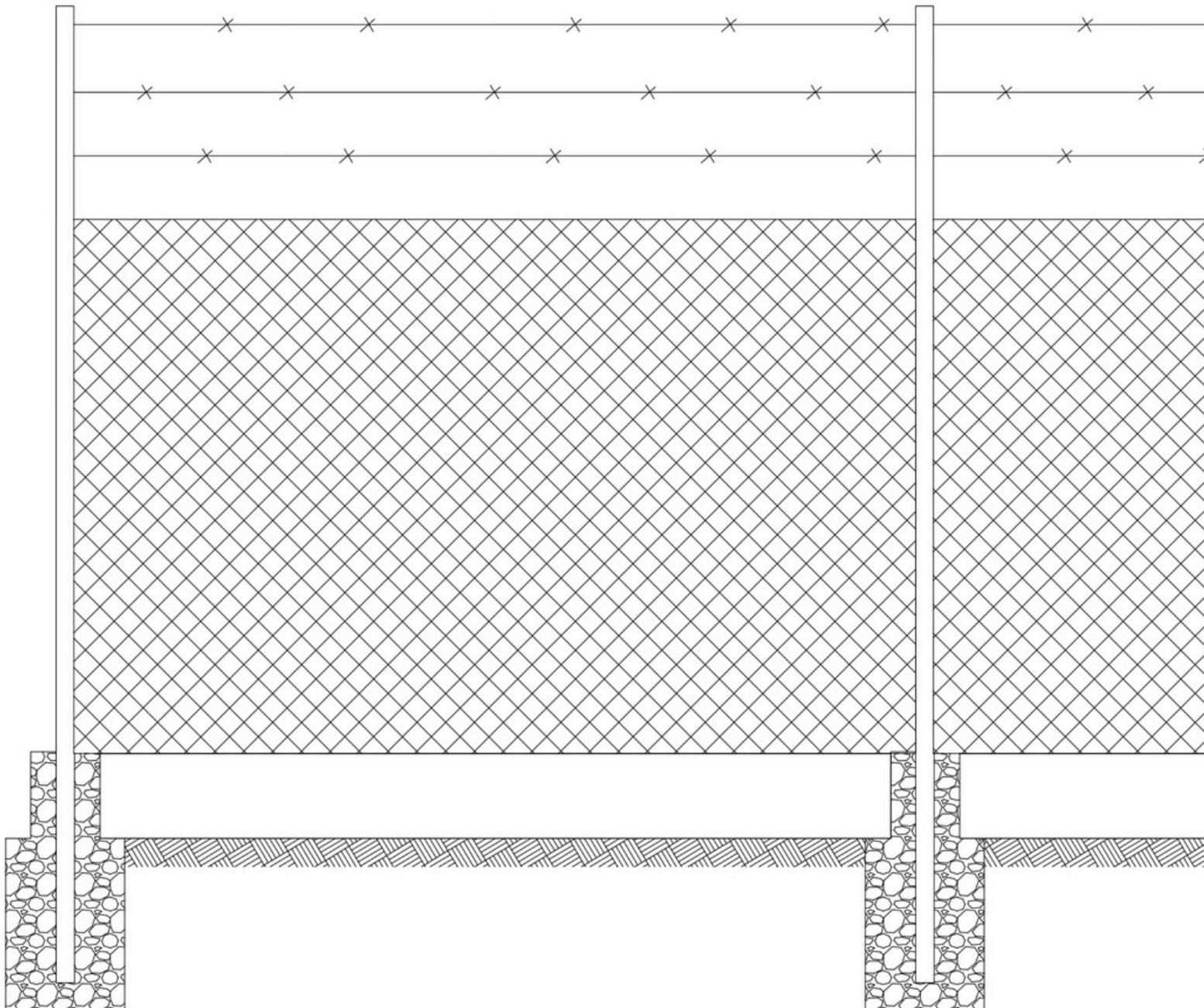
Generalmente en terrenos blandos, se realizan bases de hormigón para los postes, hormigonando además un cordón inferior una vez colocado el alambre tejido, para fijarlo adecuadamente al terreno.
