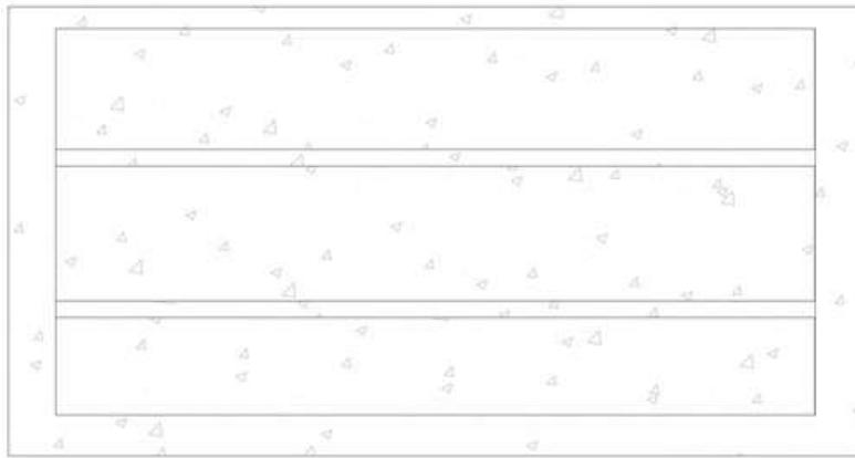
Los tanques bebederos se confeccionan con placas de hormigón premoldeadas de 1,30mx0,70m, abulonadas entre sí con espárragos de 3/8. Se le realiza el piso de hormigón elaborado con estructura de malla cima, cordón viga perimetral exterior con hierros y estribos, uniendo piso con viga para hormigonar todo junto formando una sola pieza. Salidas de agua, desborde, tomados de juntas elásticas.
